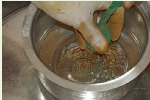
Abb.4: Filtern von Quecksilber
